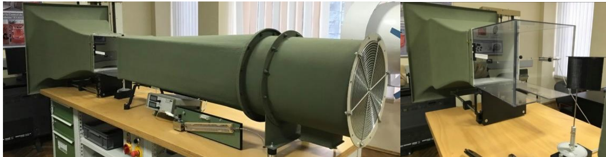
Testarea segmentelor de pale aerodinamice în tunelul de vânt Gunt HM 170.
