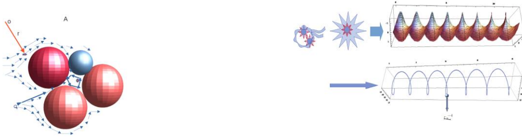
Fig. 5 Picăturile contaminate cu patogeni (A) cu dimensiuni de aproximativ 10-100nm pot fi pompate și impuse sub accelerație de rotație între spațiul liber al ansamblului elicoidal al fibrelor înrolate (B). Atingând zona evanescentă a radiației UVC a fiecărei fibre, agenții patogeni pot fi inactivați eficient.
