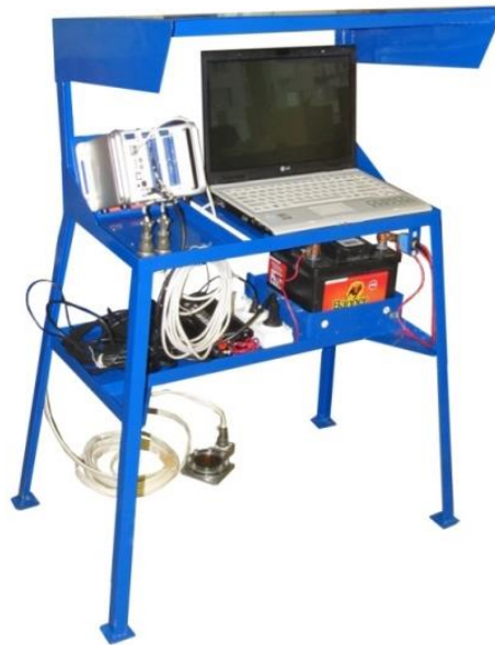
Fig. 5.2.1. – Stația tensometrică Q.brixx Gantner și procesul de testare a momentului de torsiune
