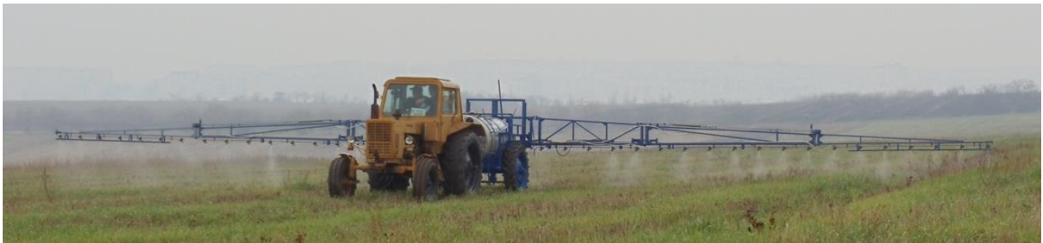
Fig. 5.3.2. Mașină de stropit STR-21-2000 în timpul lucrului
