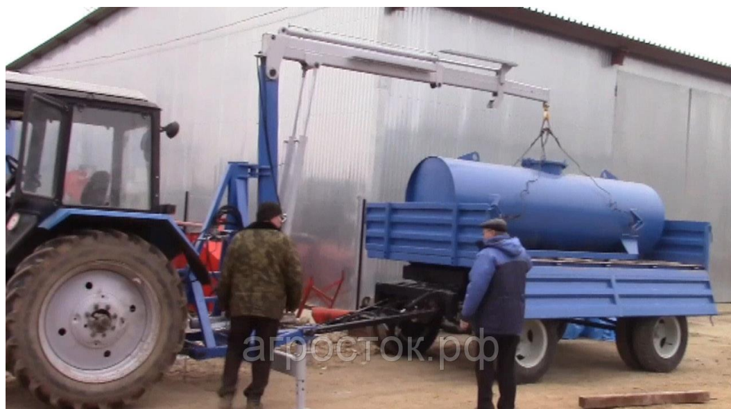
Fig.5.6.3. Manipulator KМУ, cu braț rotitor, atașabil la tractor Capacitate maximă declarată 1500 kg Preț 150000 lei
