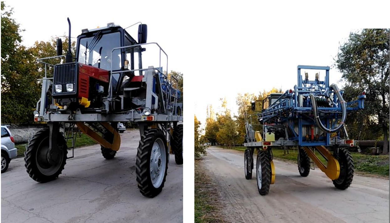
Fig.5.1.3. Mașina MSA-1700s supusă încercărilor pe drumurile publice
