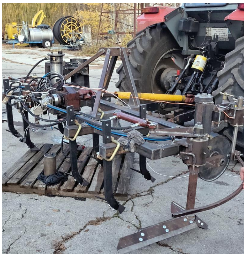
Fig. 5.7.2. Vederea generală a cultivatorului pentru lucrarea solului în plantațiile multianuale în timpul încercărilor.
